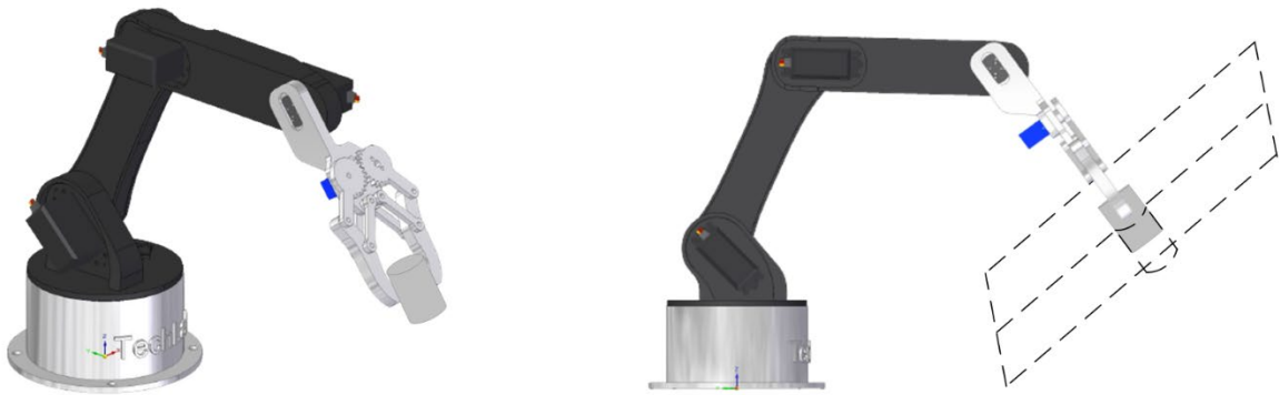
Slika 3.4. Promjena kinematičke strukture u postupku montaže
